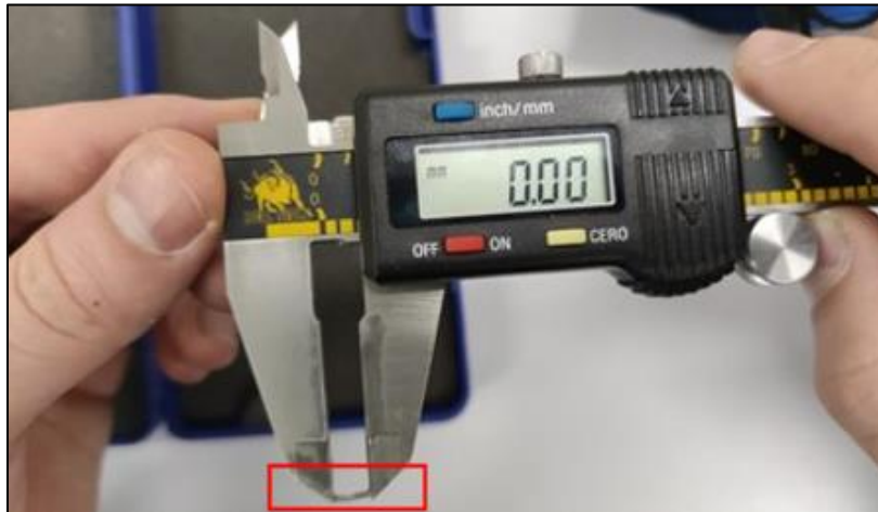
Figura 7.8 Calibrador digital modificado con inserción en las mordazas para medidas internas
