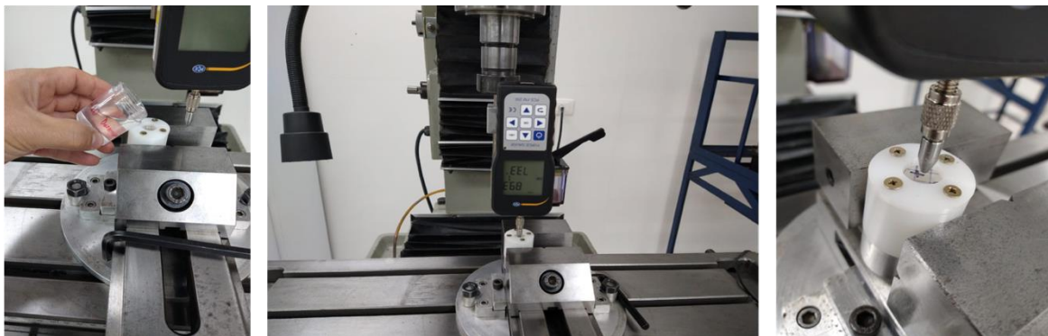
Figura 38 Prueba de relajación de esfuerzos
