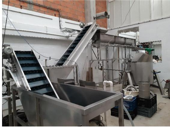
Figura 21 Aumento de la altura de la despulpadora
