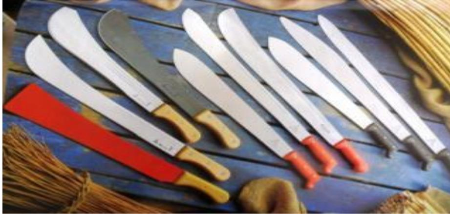
⇒ Fabricados en acero aleado al carbono, templado y revenido y con un tratamiento de laminado en la hoja para un mejor corte, con mando de plástico en polipropileno de alto impacto flexible para una mejor disposición de trabajo, con mango de madera especial de fibras longitudinales para un mejor aprovechamiento ergonómico de su estructura.
