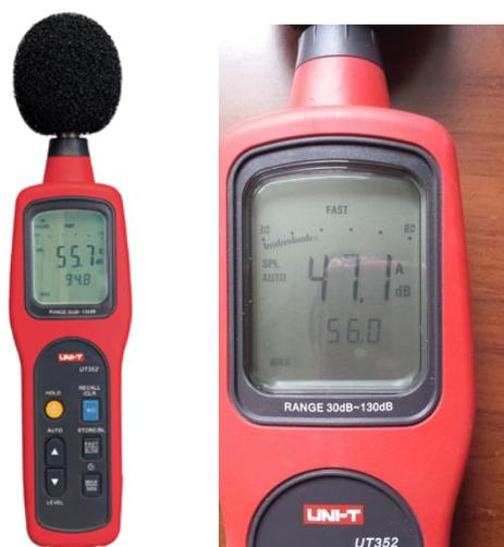
Figura 34: Sonómetro utilizado en las pruebas
