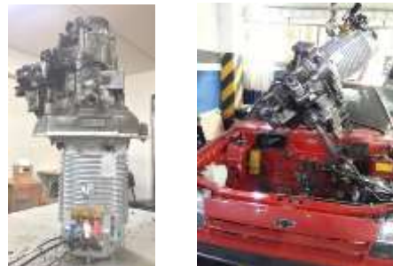
Figura 10: Ensamble y montaje de motor eléctrico y caja acoplados
