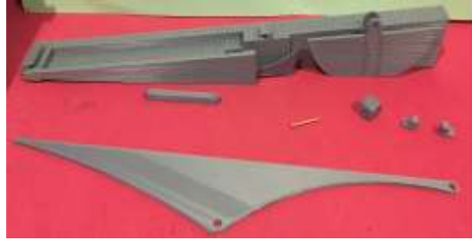
Figura 6. Piezas del mecanismo MBC impresas en PLA.
