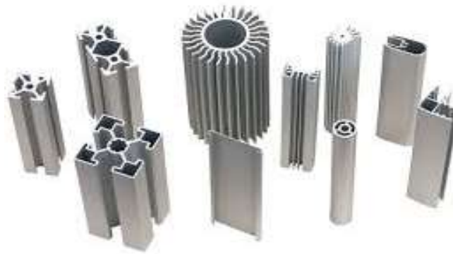
Figura 2. Formas complejas obtenidas con el proceso de extrusión directa. Tomada del Groover. [1]
