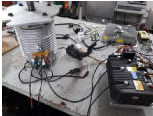
Figura 7: Ensamble de pruebas (en vacío) iniciales del motor
