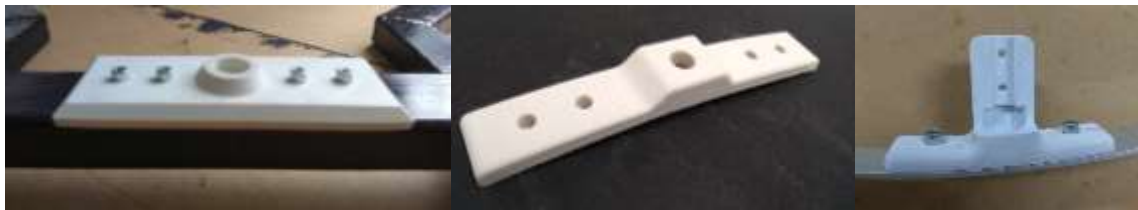
Figura 2. Piezas de acople obtenidas por impresión 3D
