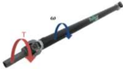
Figura 7. Fuerzas externas que actúan sobre el árbol de transmisión.
