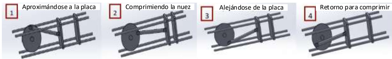
Figura 1. Secuencia de mecanismo biela-manivela del diseño uno. (Fuente: Autores)
