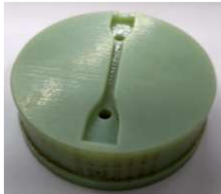
Figura 3: Inserto realizado con tecnología polyjet. Grupo de investigación GITEM UAO
