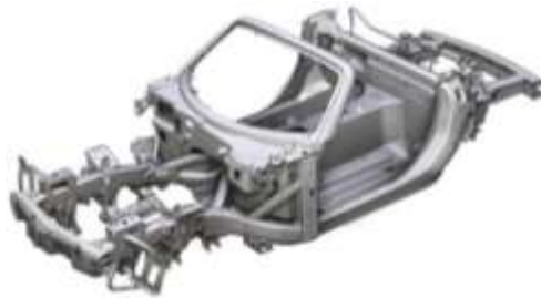
Figura 3: estructura monocasco de automóvil, basada en rieles hidroformados Se extienden desde la punta hacia el torpedo, doblándose hacia afuera y hacia abajo por debajo de la carrocería, para volver a ascender y ampliarse en sección en la parte trasera
