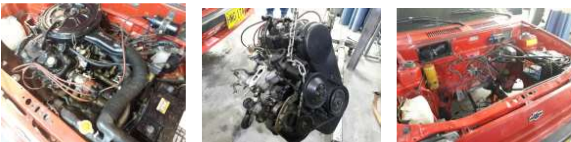
Figura 8: Imágenes del proceso de desmontaje del motor de combustión (de izquierda a derecha: motor ensamblado, retirada del motor, habitáculo sin motor)
