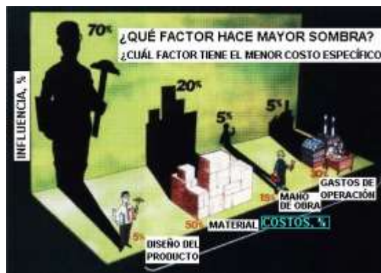
Figura 2: influencia estimada de los errores cometidos en los diferentes factores de costo asociados al desarrollo de un producto, sobre el costo generado por un rediseño.
