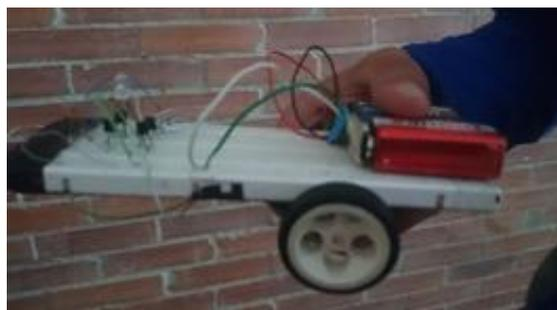
**Ilustración 35: Robot seguidor de luz.**
