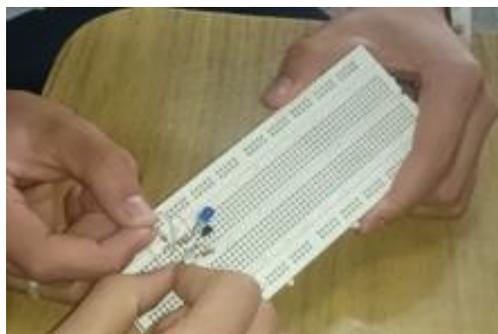
**Ilustración 33:** *Circuito detector de ausencia de luz.*
