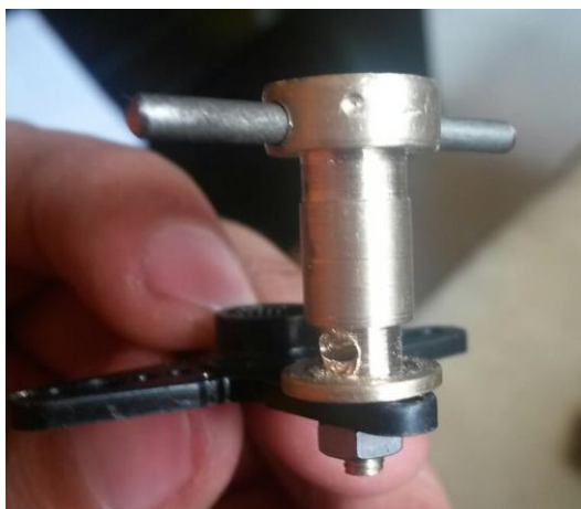
Figura 115 : tensor instalado en base de servomotor
