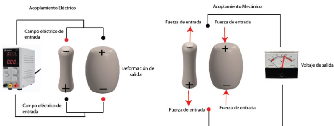
Figura 9 Modos de acoplamiento electromecánico
