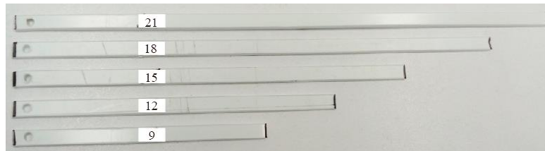
Figura 27 Longitudes en centímetros de las vigas utilizados en los experimentos
