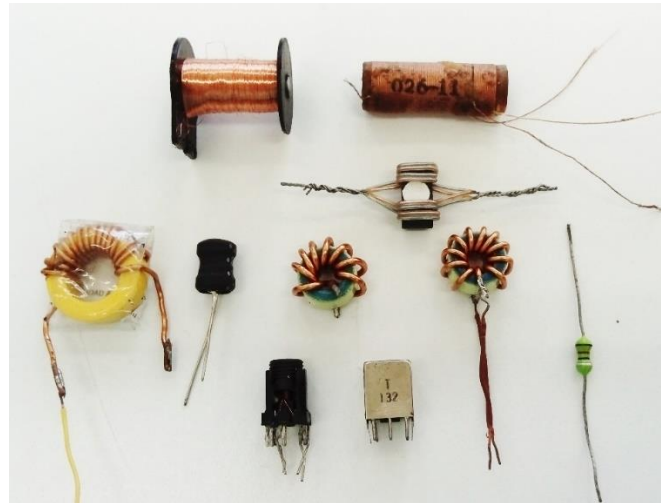
Figura 14 Tipos y tamaños de bobinas de inducción
