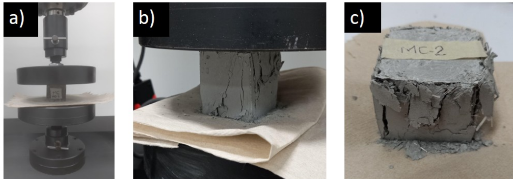
Figura 7-20: a) Montaje inicial de la prueba de compresión, b) aplicación de la carga en la muestra, c) Fractura de la probeta
