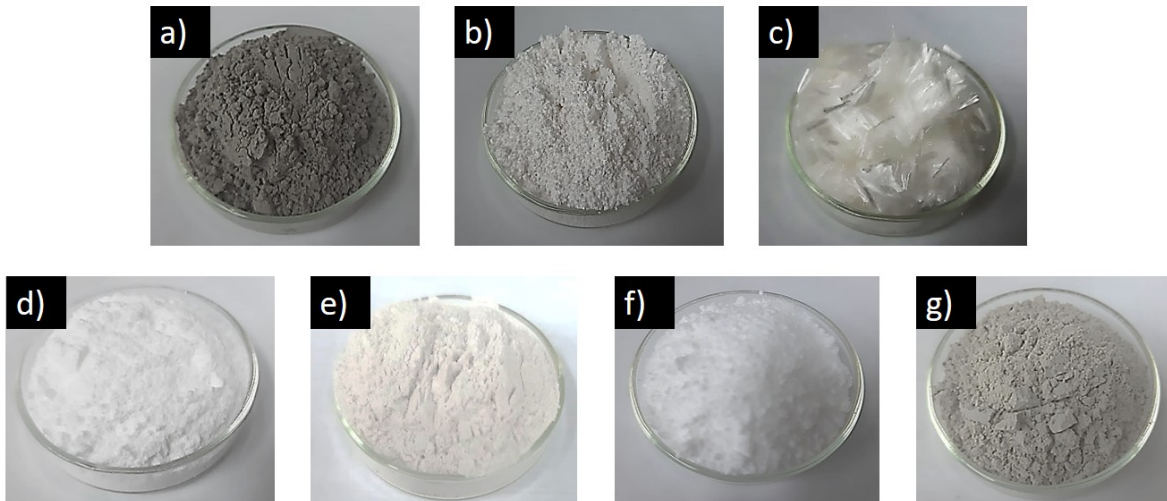
Figura 6-11: Materia prima utilizada para la elaboración de las placas de fibrocemento: a) cemento, b) carbonato de calcio, c) fibra PVA, d) fibra de celulosa, e) micropartículas de sílice, f) nanopartículas de sílice, g) bentonita. Fuente propia
