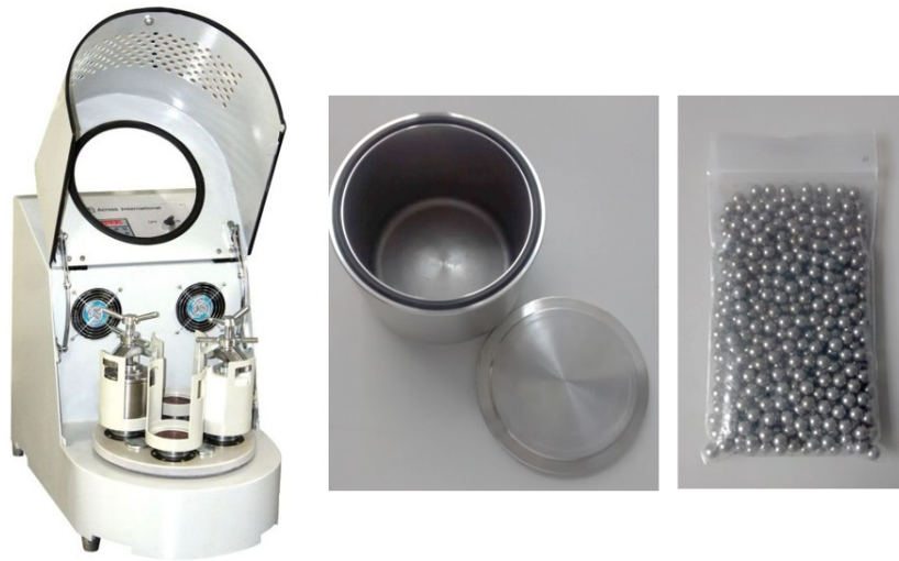
Figura 6-8: Molino planetario de alta energía usado para la obtención de NPs de sílice.
