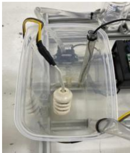
Figura 17. Depósito de agua y sistema de calentamiento.
