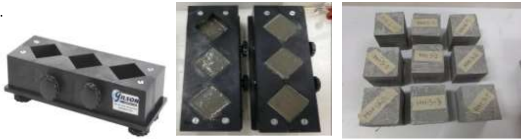
Figura 23. Elaboración de muestras para compresión a) Molde triple de plástico b) Mezcla en moldes c) Briquetas secas
