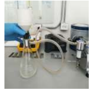
Figura 18. Lixiviación ácida a) HCl 37% b) Preparación de solución 1M, 2M, 3M c) Tratamiento químico, d) filtrado de la sílice
