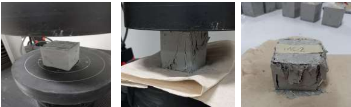
Figura 25. Ensayo de compresión a) Momento inicial de la prueba b) Carga en la muestra c) Fractura
