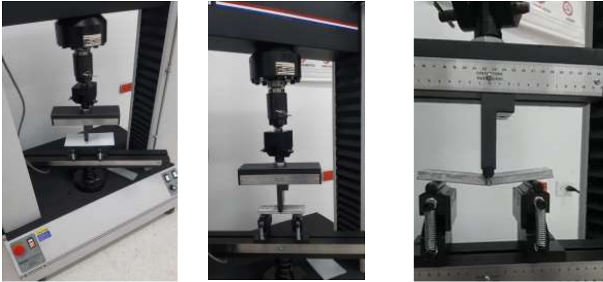
Figura 29. Prueba de Flexión a) Momento inicial de la muestra b) Prueba de flexión tres puntas c) Fractura
