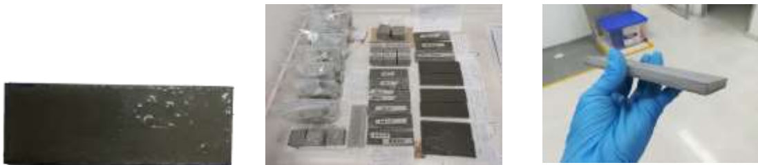
Figura 24. Proceso de elaboración de muestras de fibrocemento) Molde para briqueta de flexión b) Mezcla en moldes c) Briquetas secas
