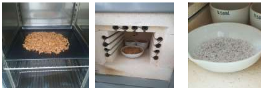
Figura 17. Proceso de obtención de ceniza de cascarilla de arroz a) Secado en horno de convección forzada, b) Incineración en mufla, c) Producto final
