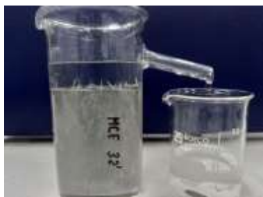
Figura 35. Proceso de medición de la densidad a) Principio de Arquímedes b) Peso inicial c) Peso sumergido
