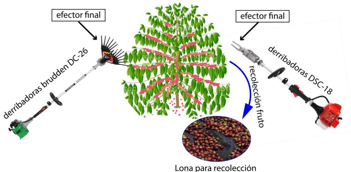
Figura 1.2. Derribadoras de café. Tomado y adaptado de [Oliveros et al. \(2005\)](#)
