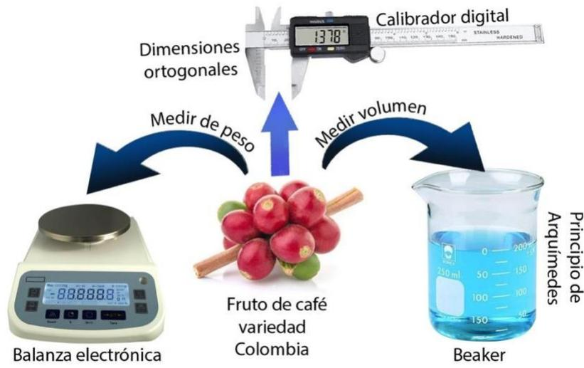
Figura 2.12. Medición experimental de dimensiones, peso y densidad del café Var. Colombia. Adaptado de [Tobón et al. \(1999\)](#)
