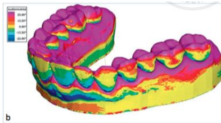
Figura 27 Modificaciones del espesor con el proceso de termoformado
