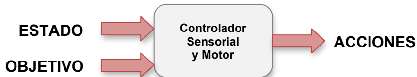
Figura 15. Modo general de un control robótico. Fuente: Adaptado de Liu, J. & Wu, J. (2001). Multi-Agent Robotic Systems. Boca Ratón, USA. CRC Press.
